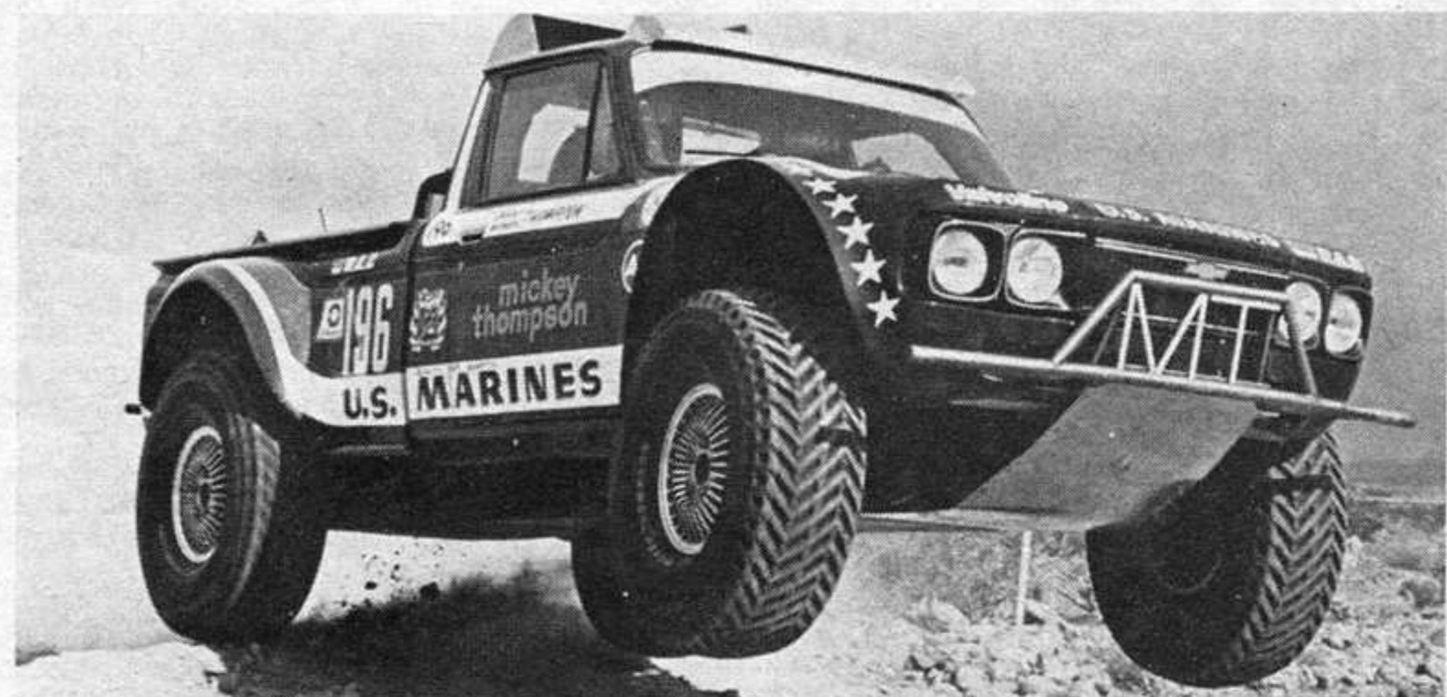
Lo speciale camioncino a 4 ruote motrici con un 6 litri Chevrolet piazzato dietro la cabina costruito da Mike Thompson. Velocità massima 160 kmh
