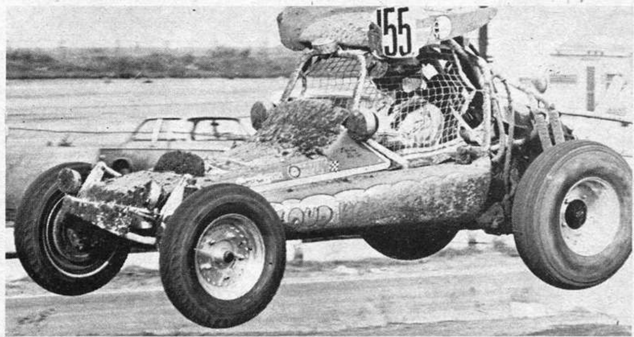
Lo speciale camioncino a 4 ruote motrici con un 6 litri Chevrolet piazzato dietro la cabina costruito da Mike Thompson. Velocità massima 160 kmh
