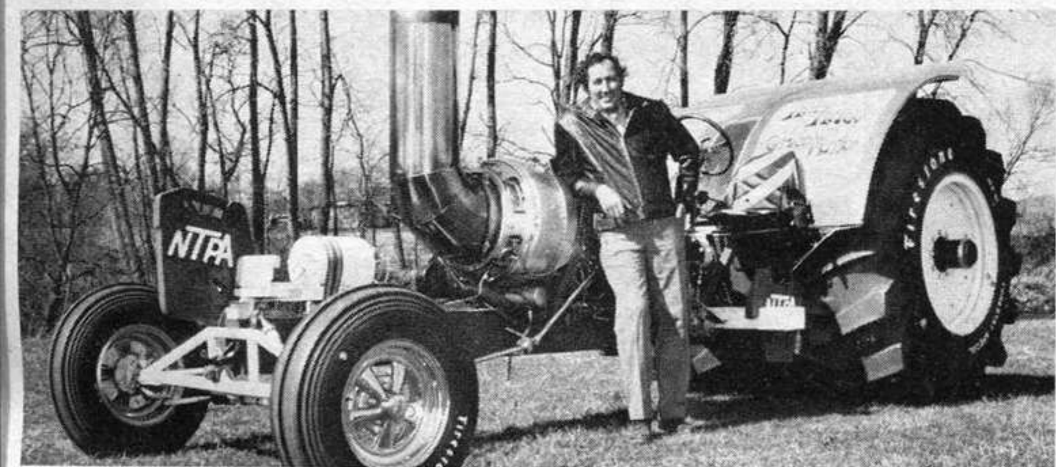
Qui sopra, l'ex-campione di velocità, Art Arfons, posa con il suo trattore specialissimo dotato di una turbina a gas. A destra, un Buggy monopo- sto con meccanica VW. Notare l'alettone e la rete a protezione dai sassi
