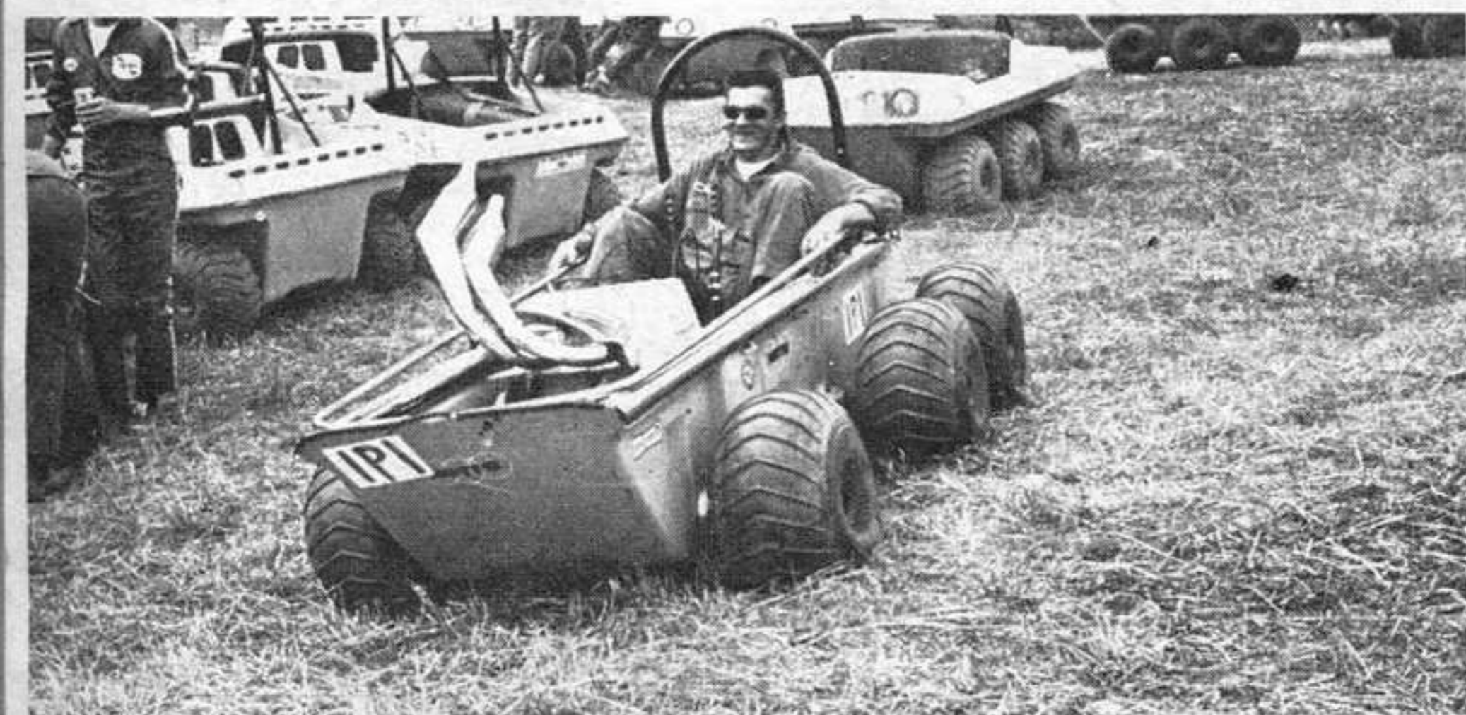
Un ATV (all terrain vehicle) prima di una gara. Si nota il particolare disegno dei pneumatici, che danno trazione sufficiente anche nell'acqua
