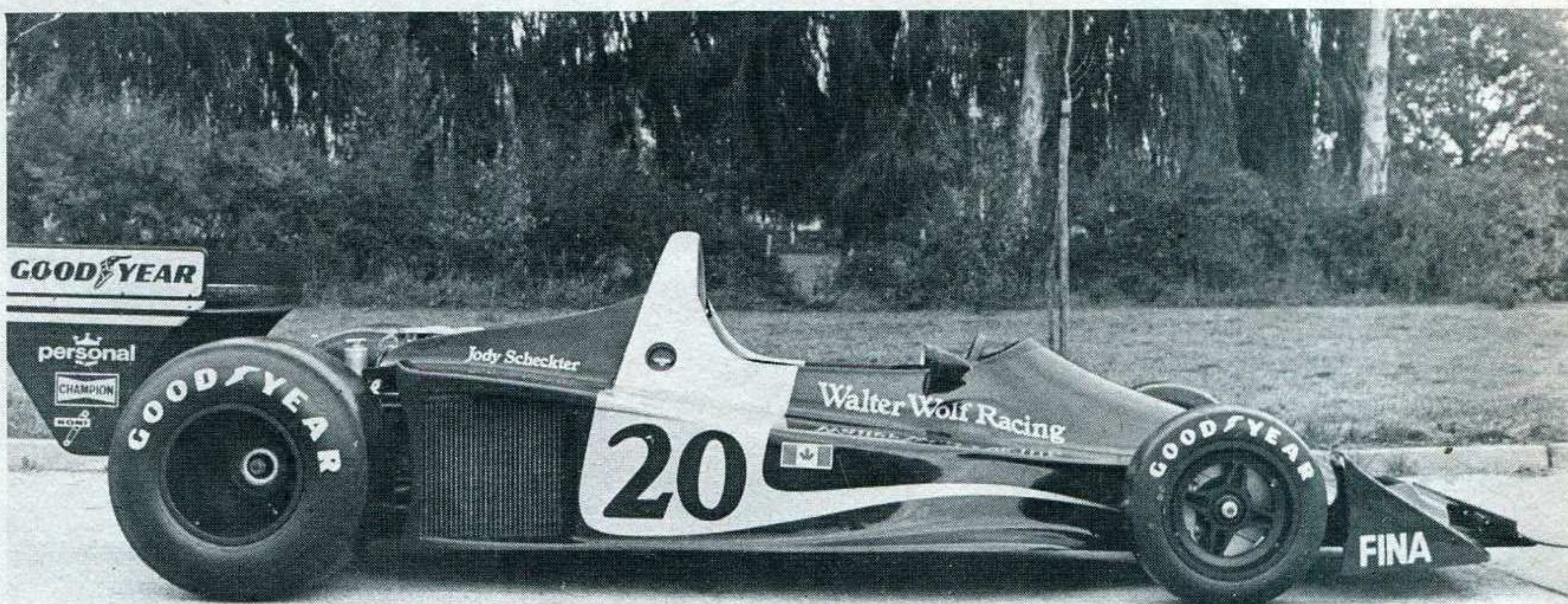
Triangoli sovrapposti per la sospensione anteriore. Sotto, la linea decisamente a cuneo della Wolf
