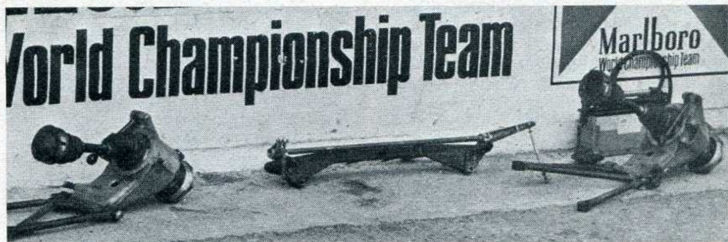
Un gruppo sospensione posteriore provato dalla Ferrari ad Imola. La Goodyear ha quasi pronte le speciali coperture previste per il De Dion integrale
